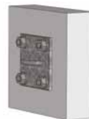
Etape 4 : Positionner les 4 rondelles et serrez fermement les écrous (rondelles et écrous non fournis).
